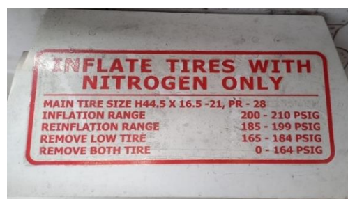
Gambar 3. 13 Main Wheel Pound per square inch gauge.(sumber: dokumentasi pribadi)
