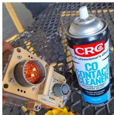
Gambar 4. 17 Contact Cleaner (sumber: dokumentasi pribadi)
