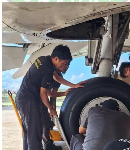
Gambar 4. 14 Diassembly wheel (sumber: dokumentasi pribadi)
