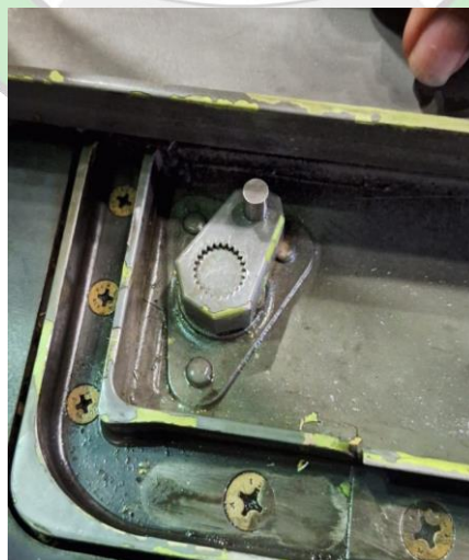
Gambar 4. 11 Lokasi Camshaft (sumber: dokumentasi pribadi)
