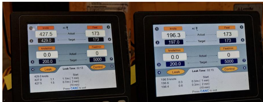
Gambar 4. 8 Test leak check dengan ADC tester
