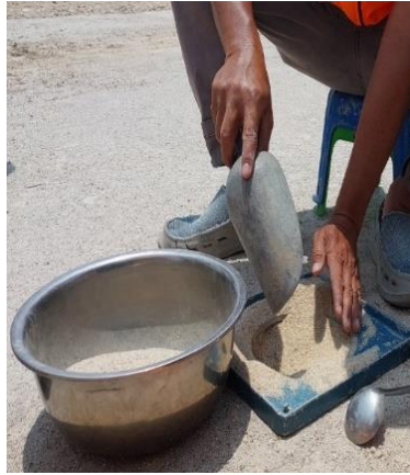
Gambar 4. 26 Membersihkan Titik Galian (Sumber : Dokumentasi Penulis, 2024)
