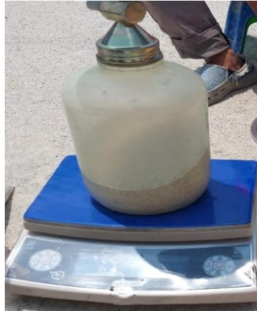
Gambar 4. 32 Menimbang Sisa Pasir (Sumber : Dokumentasi Penulis, 2024)
