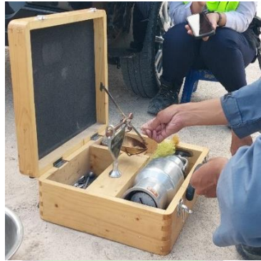
Gambar 4. 34 Menghaluskan Sampel Sebelum Ditimbang (Sumber : Dokumentasi Penulis, 2024)
