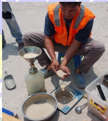
Gambar 4. 33 Memasukkan Pasir untuk Digunakan Kembali (Sumber : Dokumentasi Penulis, 2024)
