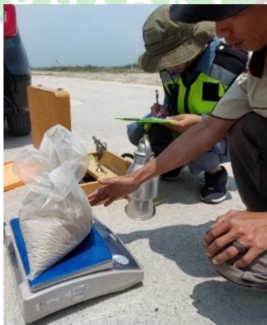
Gambar 4. 28 Menimbang Sample Galian (Sumber : Dokumentasi Penulis, 2024)
