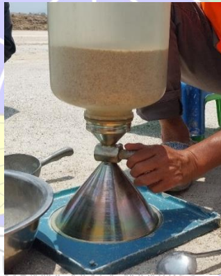
Gambar 4. 30 Mengisi Lubang Galian dengan Pasir (Sumber : Dokumentasi Penulis, 2024)
