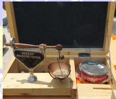
Gambar 4. 35 Menimbang Sampel (Sumber : Dokumentasi Penulis, 2024)
