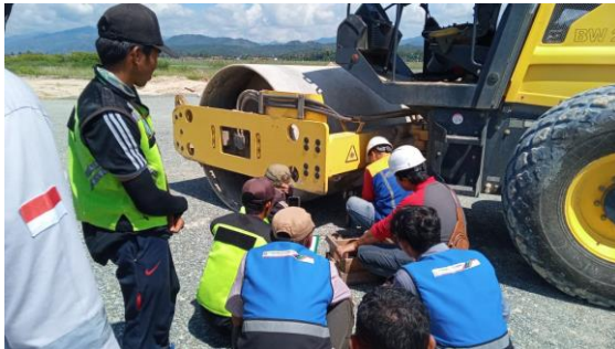
Tes CBR Pada Agregat
