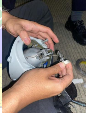
Gambar 4. 13 Melepas Lampu LED (Sumber: Dokumen Pribadi)
