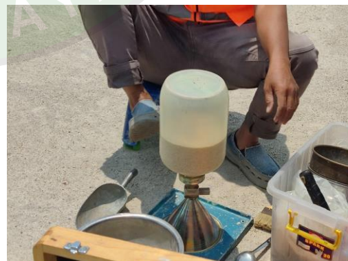
Pengujian sandcone subgrade apron baru bersama tim lab
