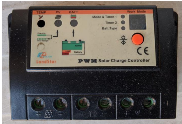
Gambar 3. 7 Solar Charger Control Sumber : Penulis, 2023
