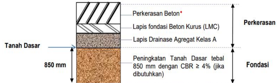
Gambar 3. 4 Tipikal Lapisan Perkerasan Kaku Pada Galian
