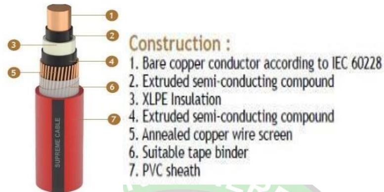
Gambar 3. 7 Kontruksi Kabel FL2XCY
