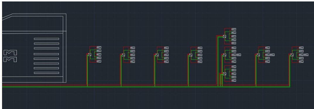
Gambar 4. 5 Perencanaan layout jalur kabel ke trafo
