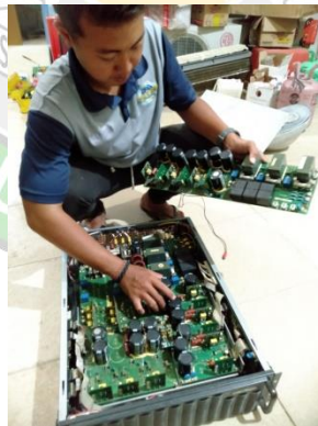
Gambar 4. 8 Tukar PCB Pada Modul
