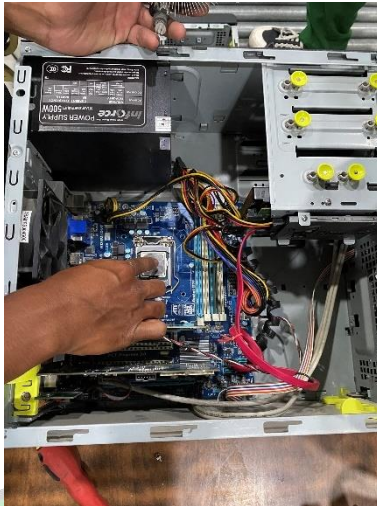
Gambar 3. 35 Penggantian thermal paste Sumber: Dokumentasi Penulis 21 Februari 2024
