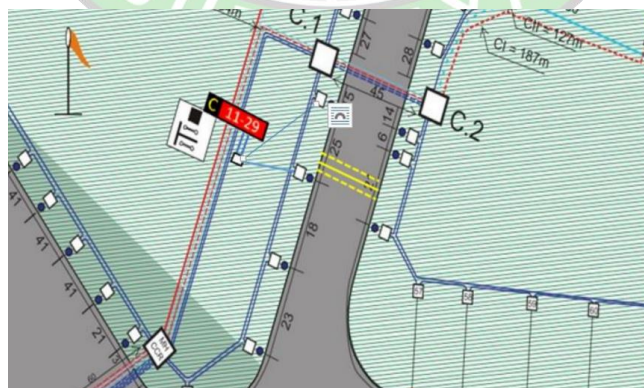
Gambar 4. 1 Wiring Taxiway C Tempat Pemasangan RDS C
