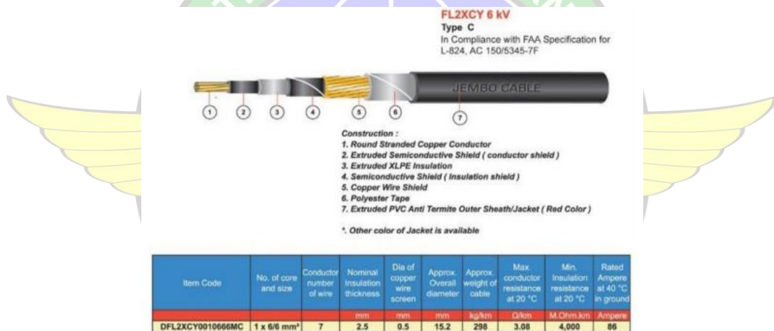
Gambar 3. 4 Konstruksi Kabel FL2XCY
