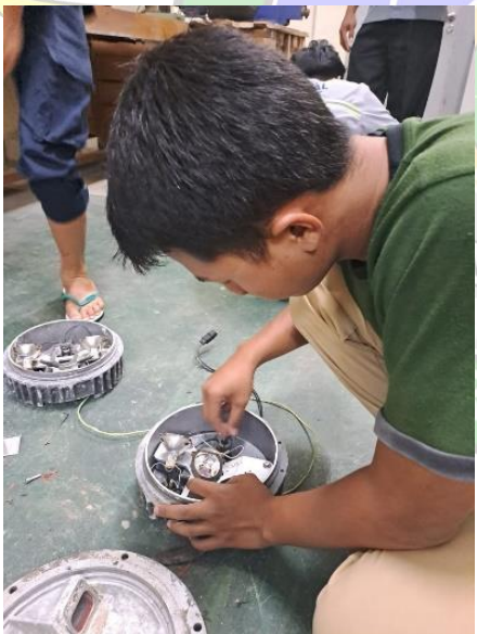
Gambar 5. 4 perakitan lampu inset
