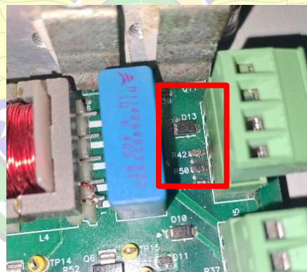
Gambar 4. 5 Bagian modul yang terbakar Sumber : Dokumentasi penulis
