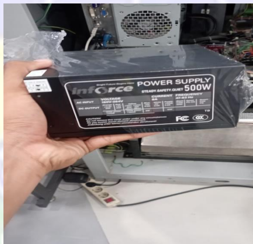
Gambar 3. 32 Pergatian Power Supply yang baru Sumber : Dokumentasi penulis 2024
