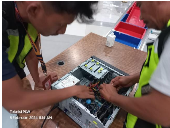
Gambar 3. 31 Percobaan Pengetesan Power supply Sumber : Dokumentasi penulis 2024
