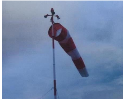
Gambar 2. 10 Wind Direction Indicator Sumber : Dokumentasi Pribadi
