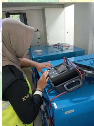
Gambar 4. 7 Proses Pengukuran Tahanan Isolasi Secara Keseluruhan Sumber : Dokumentasi Pribadi
