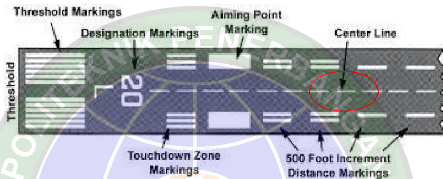
Gambar 3.4 Daerah Runway Center Line Marking
