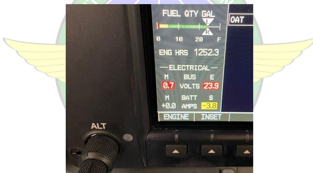
Gambar 4. 1 Standby Battery Tidak Charging
