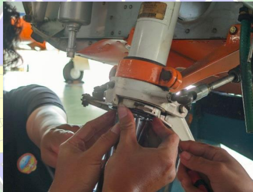
Gambar 4. 19 Pemasangan lock ring pada alur ujung bawah pada top strut
