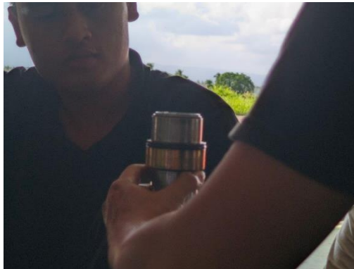
Gambar 4. 18 Instalasi bearing dan lock ring pada ujung atas bottom strut
