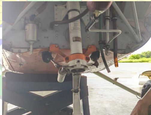
Gambar 4. 17 Kondisi setelah bottom strut terpisah dengan top strut
