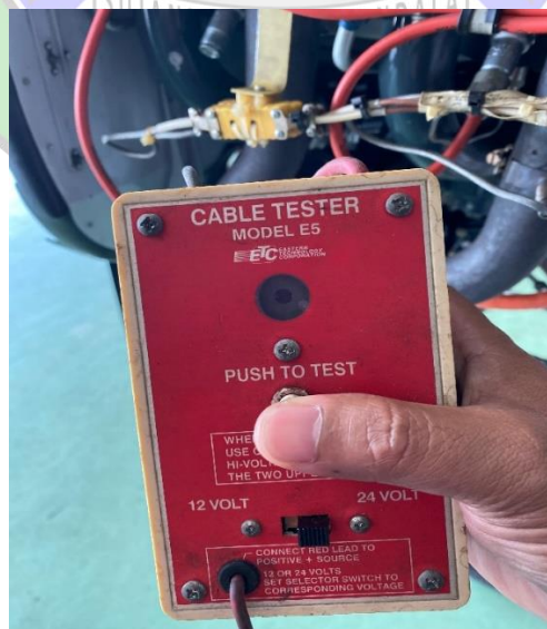
Gambar 4.13 pengecekan kabel harness menggunakan harness tester
