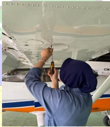
Gambar 4. 11 Melepas Screw pada wing panel
