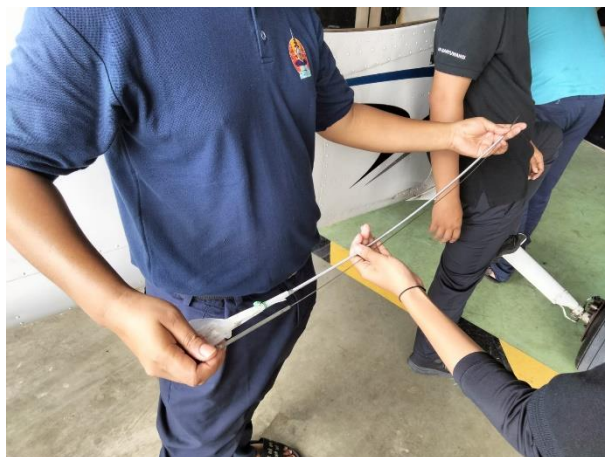
Gambar 4. 15 Replace pada fuel shutoff valve control cable sesuai part Number S1533-9
