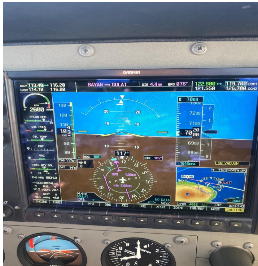
Gambar 4. 8 Low vacuum pada Garmin 1000
