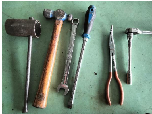
Gambar 4. 18 Tool yang digunakan untuk melepas left main wheel
