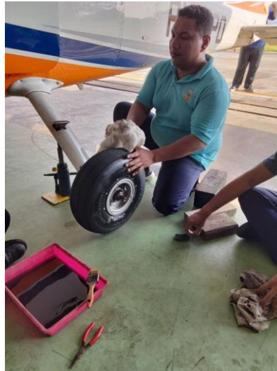
Gambar 4. 21 Setelah dilakukan replace pada main wheel
