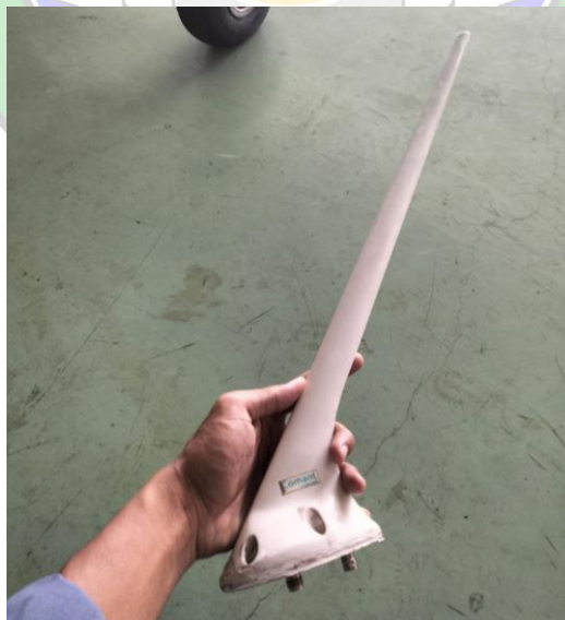
Gambar 4. 11 Visual Inspection pada antenna
