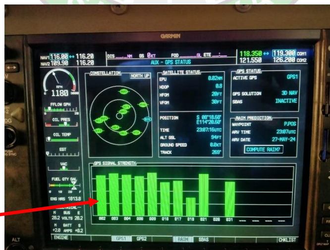
Gambar 4. 14 Functional Test pada GPS
