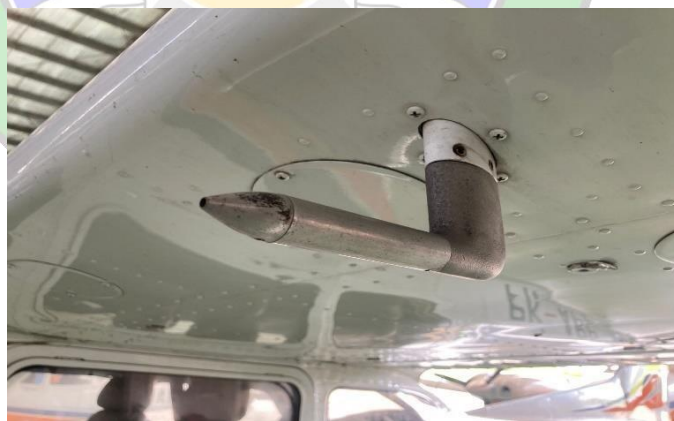
Gambar 4. 19 Penyumbatan pada Pitot Tube
