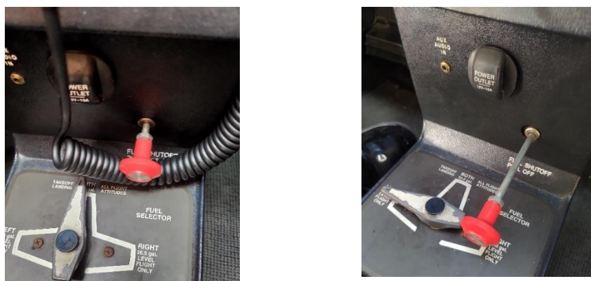
Gambar 4. 6 Funtional test pada shutoff valve control
