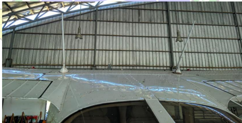
Gambar 3. 4 GPS Antenna pada pesawat Cessna 172 SP Skyhawk
