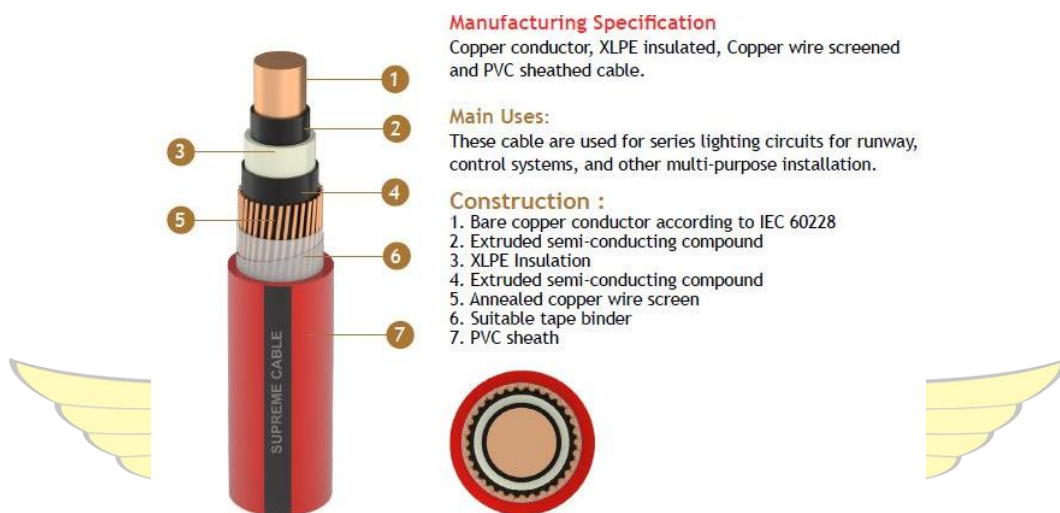
Gambar 3. 12 Konstruksi kabel FL2XCY Sumber: katalog Supreme Cable
