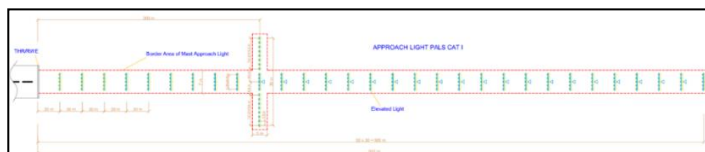
Gambar 2. 17 Penerapan konfigurasi PALS CAT I Sumber : Data Electrical
