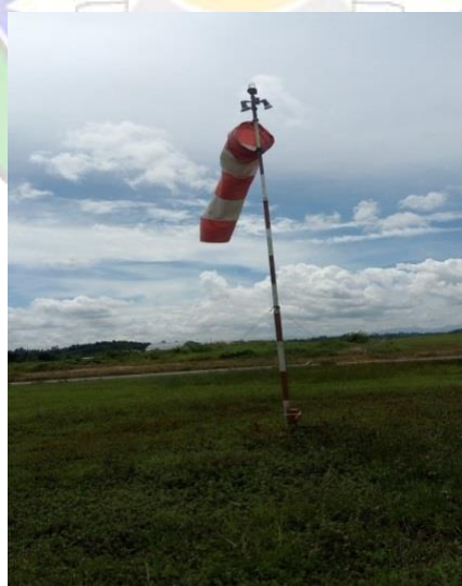
Gambar 2. 36 Wind Direction Indicator Sumber : Dokumentasi Penulis
