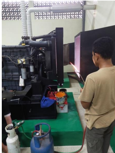
Perbaikan radiator genset
