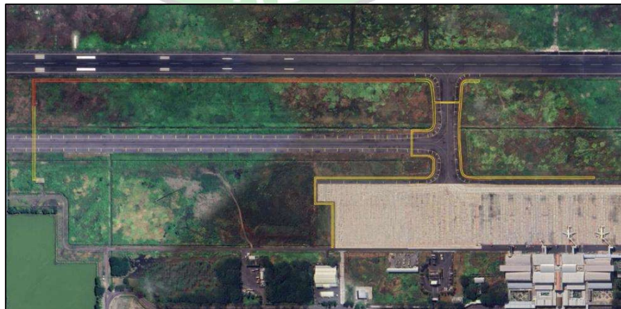
Gambar 4. 27 Area Taxiway Bravo dengan tahanan isolasi buruk
