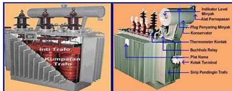
Gambar 3. 5 Kontruksi Trafo 3 fasa
