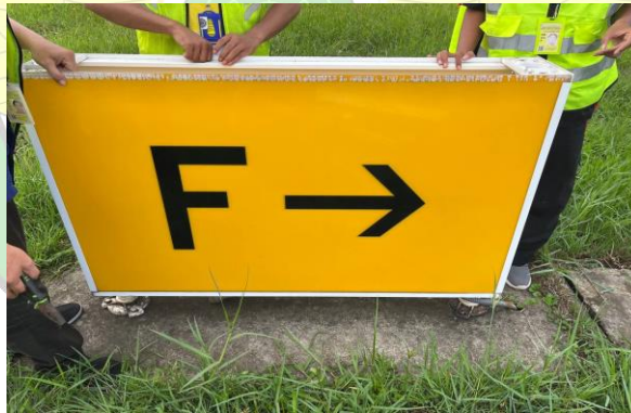
Gambar 4. 1 Taxiway Guidance Sign foxtrot Sumber: Dokumentasi penulis
