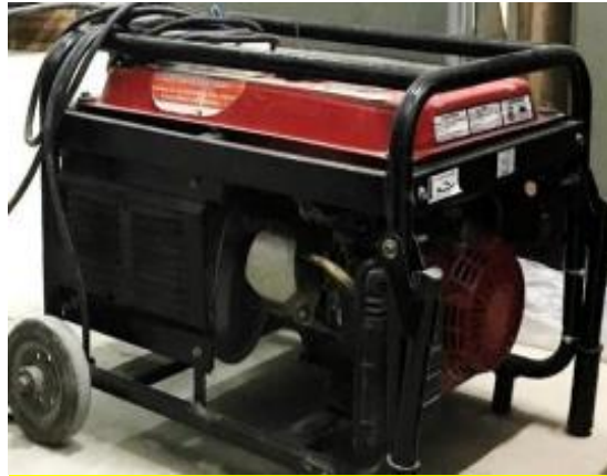
Gambar 2. 36 Genset 2500 W Sumber: Dokumentasi penulis
