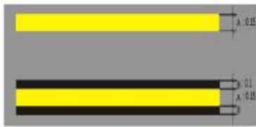
Gambar 5.2-12 Garis Lead-In dan Lead-Out untuk Pesawat Udara Paling Kritis
