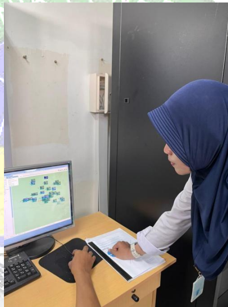
Gambar 3. 31 Monitor ADSB menunjukkan cakupan jumlah pesawat yang tertangkap oleh ADSB di Juanda saat dilakukan pengecekan Sumber: Dokumentasi Penulis 2025
