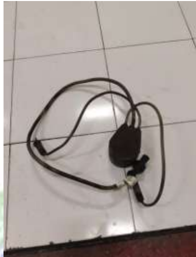
Gambar 3. 3 Trafo Runway Edge Light
