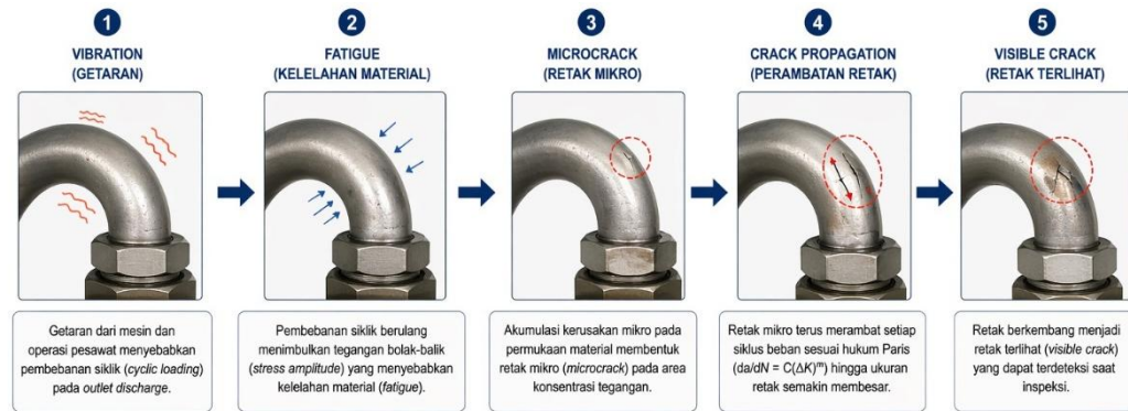
Gambar 3. 9 Failure mechanism pada crack
