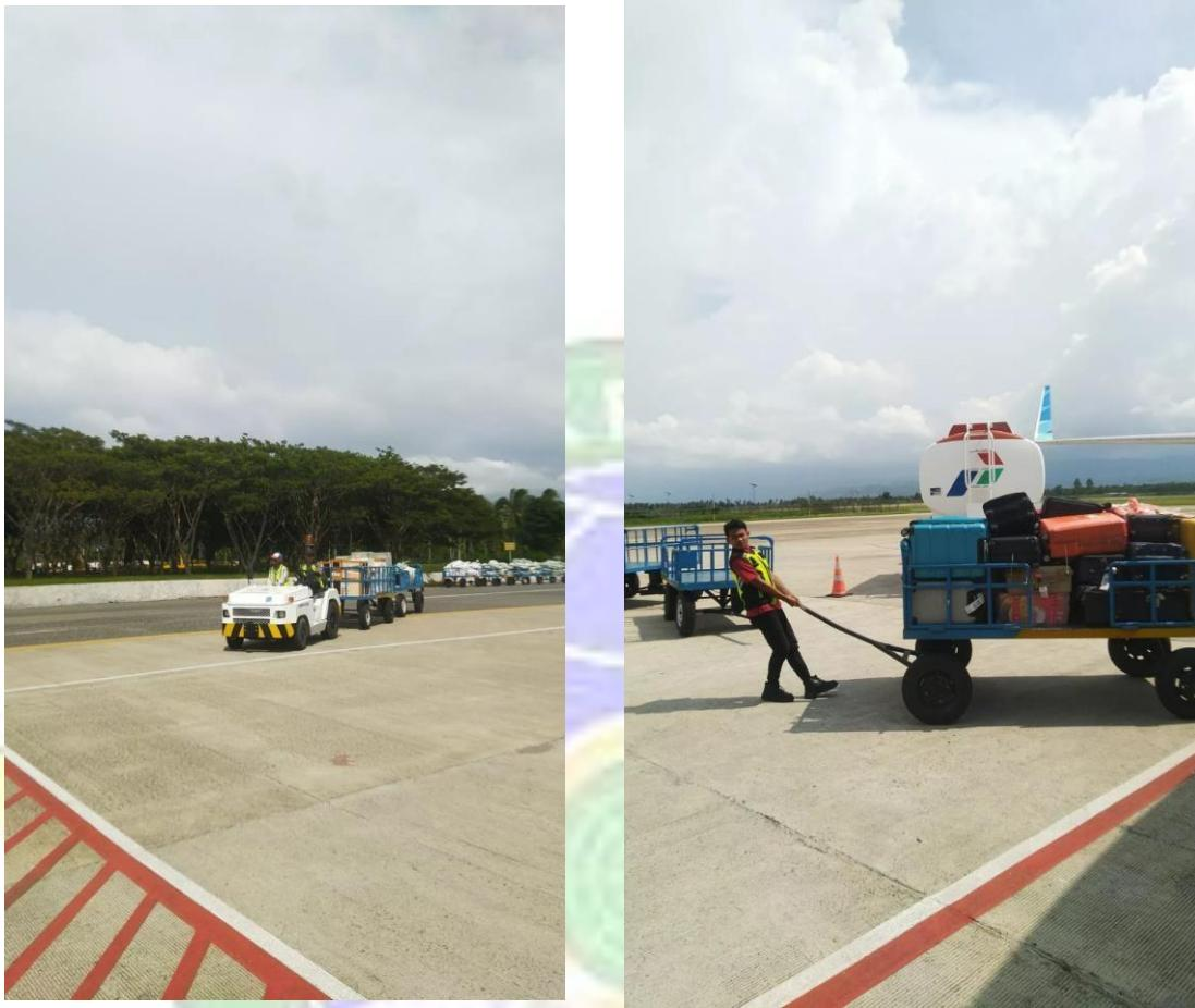
Gambar diatas menunjukkan BTT yang datang dari *apron* Alpha dan membawa muatan dari terminal kargo sehingga dengan waktu yang bersamaan operasional *baggage chart* di *apron* Bravo ditarik secara manual oleh petugas *ground handling*.
