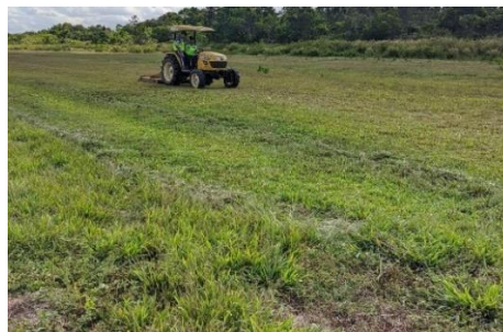
Gambar 4.16 Pemotongan Menggunakan Mower Tractor
