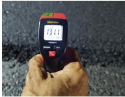
Gambar 4.31 Pengukuran Suhu Hampar
