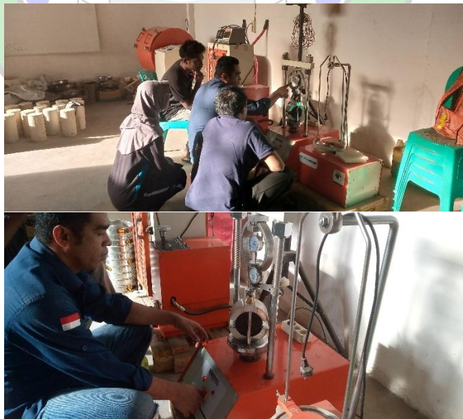
Gambar 4.53 Marshall Test (Sumber : Dokumentasi Penulis)
