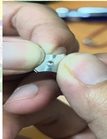
Gambar 3.27 Kondisi lempeng button forward yang pecah Sumber : Dokumentasi 20 Februari 2025
