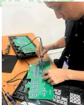
Gambar 3.30 Proses penyolderan kaki-kaki button ke keyboard control panel Sumber : Dokumentasi 20 Februari 2025
