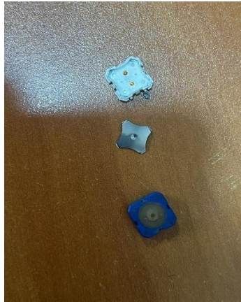
Gambar 3.28 Button lama beserta lempeng di dalam button yang pecah Sumber : Dokumentasi 20 Februari 2025
