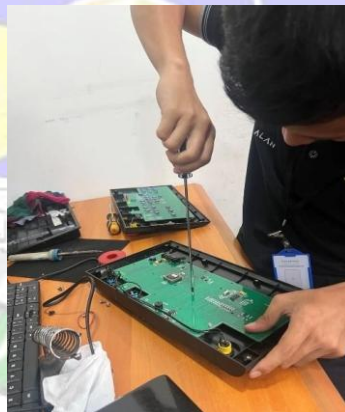
Gambar 3.32 Memasang kembali baut-baut di Keyboard Control Panel Sumber : Dokumentasi 20 Februari 2025
