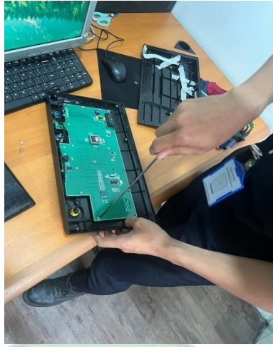
Gambar 3.26 Melepas baut di Keyboard Control Board Sumber : Dokumentasi 20 Februari 2025
