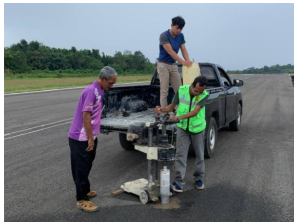
Gambar 4. 23 Pengambilan Sampel Core (Sumber : Dokumentasi penulis, 2024)
