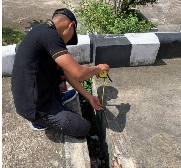
Gambar 4. 39 Pengukuran Volume Drainase
