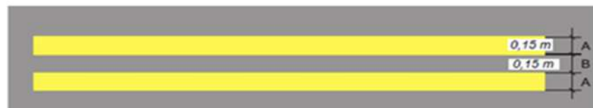
Gambar 3. 5 Marka Apron Edge (Sumber : Keputusan Direktur Jenderal Perhubungan Udara Nomor 21 Tahun 2023)
