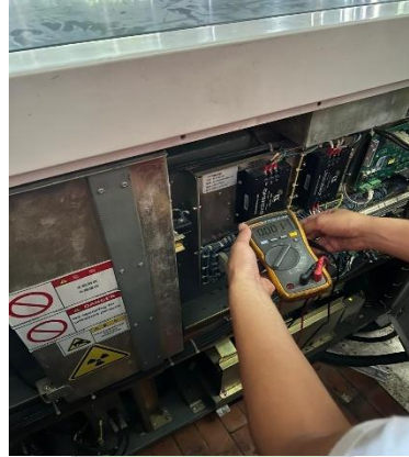
Gambar 3. 28 Pemeriksaan Tegangan dan Sumber Daya (Sumber : dokumentasi penulis 11 Februari 2025)
