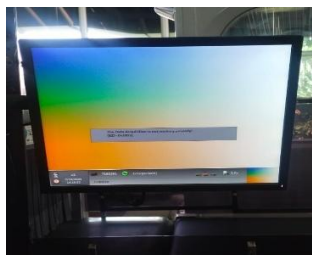
Gambar 3. 26 notifikasi dengan kode error 0x3003 di monitor (Sumber : dokumentasi penulis 11 Februari 2025)
