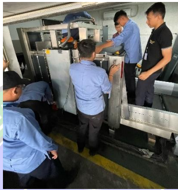
Gambar 3. 27 Pembongkaran Rangka body X-Ray untuk Akses ke Digiboard (Sumber : dokumentasi penulis 11 Februari 2025)
