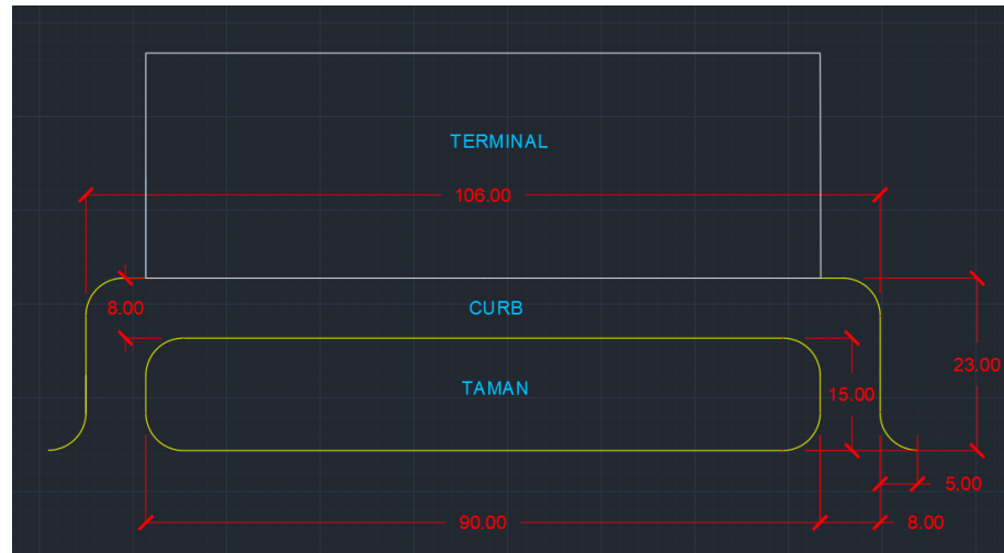
Gambar 4. 28 Layout kanstin terminal penumpang
