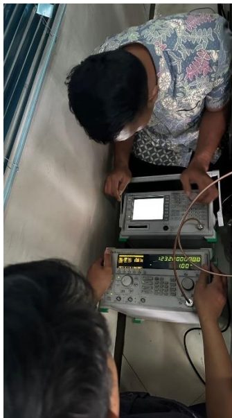
Gambar 3.11. 9 Setting ulang cavity filter di radio 123.2 Mhz Sumber: Dokumentasi Penulis 2024
