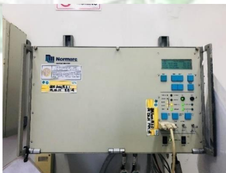
Gambar 3. 17 Front Pannel Middle Marker di Bandara Juanda Surabaya Sumber: Dokumentasi penulis 2024
