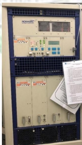
Gambar 3. 11 Front Panel Localizer merk Normac Sumber : Dokumentasi penulis 2024
