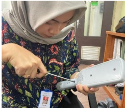
Gambar 3. 17 Pelepasan cover Handheld Metal Detector Sumber: Dokumentasi Penulis, 11 Februari 2025
