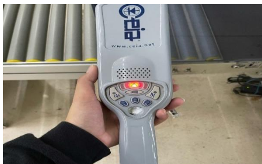
Gambar 3. 24 Hand Held Metal Detector terlihat normal Sumber: Dokumentasi Penulis, 13 Februari 2025
