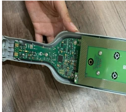
Gambar 3. 21 Kumparan Hand Held Metal Detector Rusak Sumber: Dokumentasi Penulis, 11 Februari 2025
