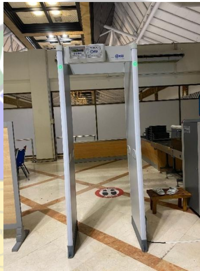
Gambar 3. 4 WTMD Merk CEIA Sumber : Dokumentasi Penulis 2025
