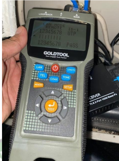
Gambar 3. 30 Pengujian Kabel LAN Menggunakan LAN Tester
