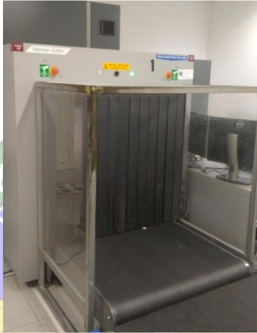
Gambar 3. 2X-Ray Bagasi Merk Rapiscan Sumber : Dokumentasi Penulis 2025
