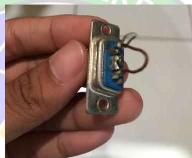
Gambar 3. 46 Konfigurasi looping DB9
