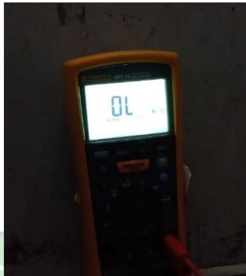
Gambar 4. 8 Pengukuran Tegangan Antara CIDS dan Bottle 1
