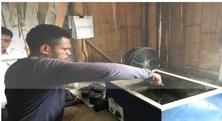
Gambar 4.10 Pengangkatan briket setelah direndam selama 24 menit
