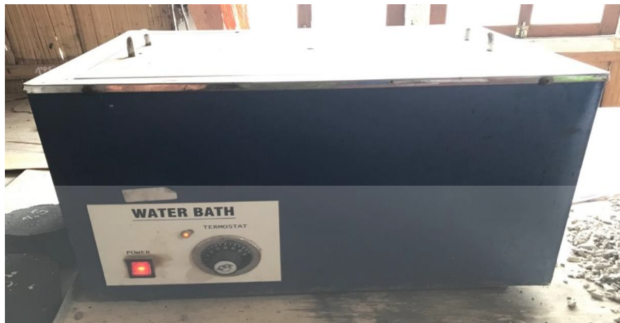
Gambar 4.8 Waterbath dengan suhu 60°
