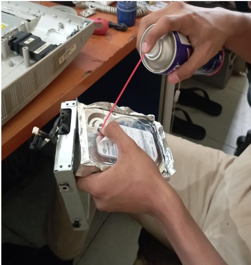
Gambar 3. 27 Pembersihan Hardisk menggunakan contact cleaner
