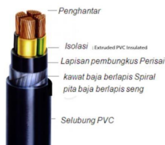
Gambar 3. 19 Kabel NYFGBY 4 X 95 mm
