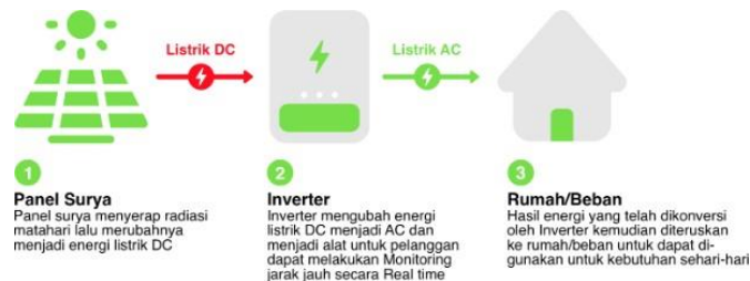
Gambar 3. 9 Cara kerja Inverter
