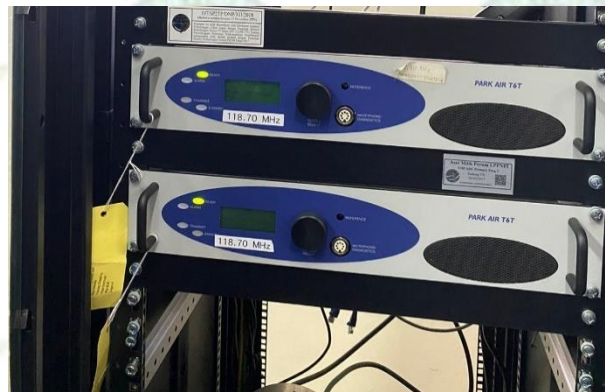
Gambar 3. 4 Peralatan VHF A/G Primary Transmitter Sumber: Dokumentasi Penulis (2023)
