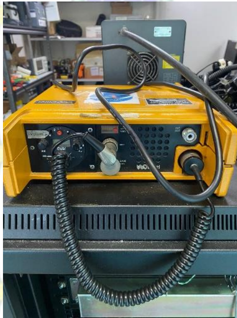
Gambar 3. 10 Peralatan VHF Transceiver (Back Up) Sumber: Dokumentasi Penulis (2023)
