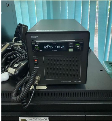
Gambar 3. 9 Peralatan VHF Transceiver ( Back Up ) Sumber: Dokumentasi Penulis (2023)
