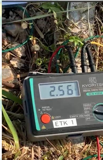
Gambar 3. 21. Pengecekan Grounding peralatan Sumber: Dokumentasi Penulis (2023)
