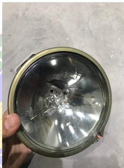
Gambar 4. 7 Lamp pada landing light yang telah rusak
