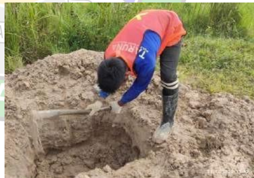
Penggalian tanah untuk tes speed
